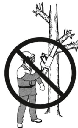
Mit der Kettensäge nicht über Schulterhöhe arbeiten. Die Kettensäge darf nie mit nur einer Hand gehalten und benutzt werden.
